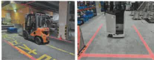
지게차 레이저빔 설치
